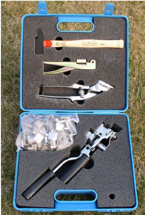
Spanngerät – Ratsche Art.-Nr.: 753/2 (Bauform kann variieren)
