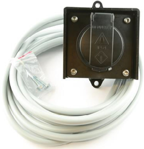
Anbausteckdose HSW 4011 (Art.-Nr. 306/1) komplett mit 4,5 m-Anschlußleitung 3x1,5 mm 2
